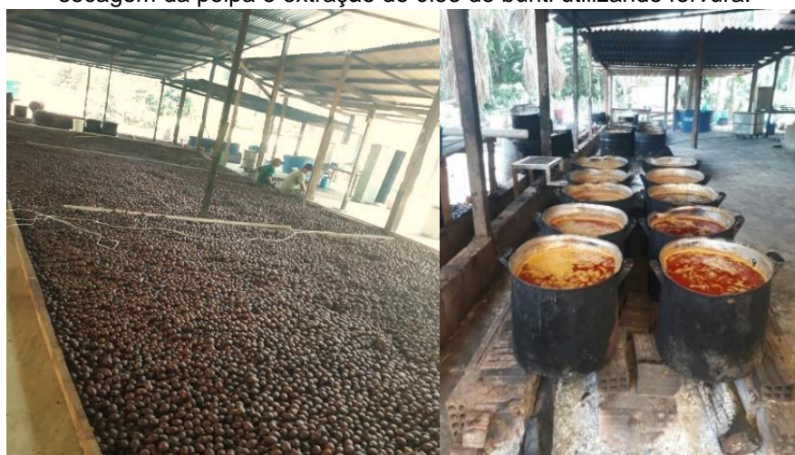
Figura 16 - Usina de produção de óleos vegetais e sabonetes do Sr. Manoel B. de Souza. Área de secagem da polpa e extração do óleo de buriti utilizando fervura.
