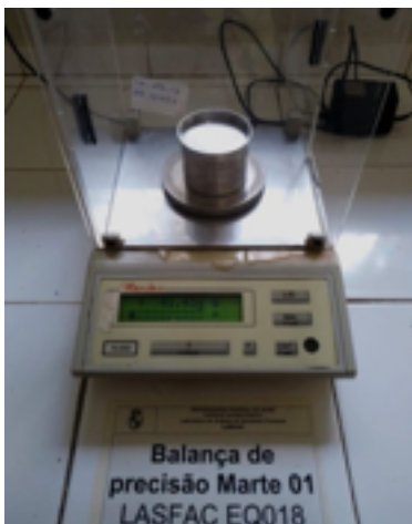
Determinação do grau de umidade de sementes. Foto: Keilysson Moraes.
