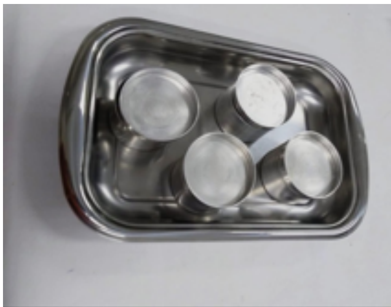
Recipientes utilizados na determinação do teor de água em sementes. Foto: Keilyson Moraes.
